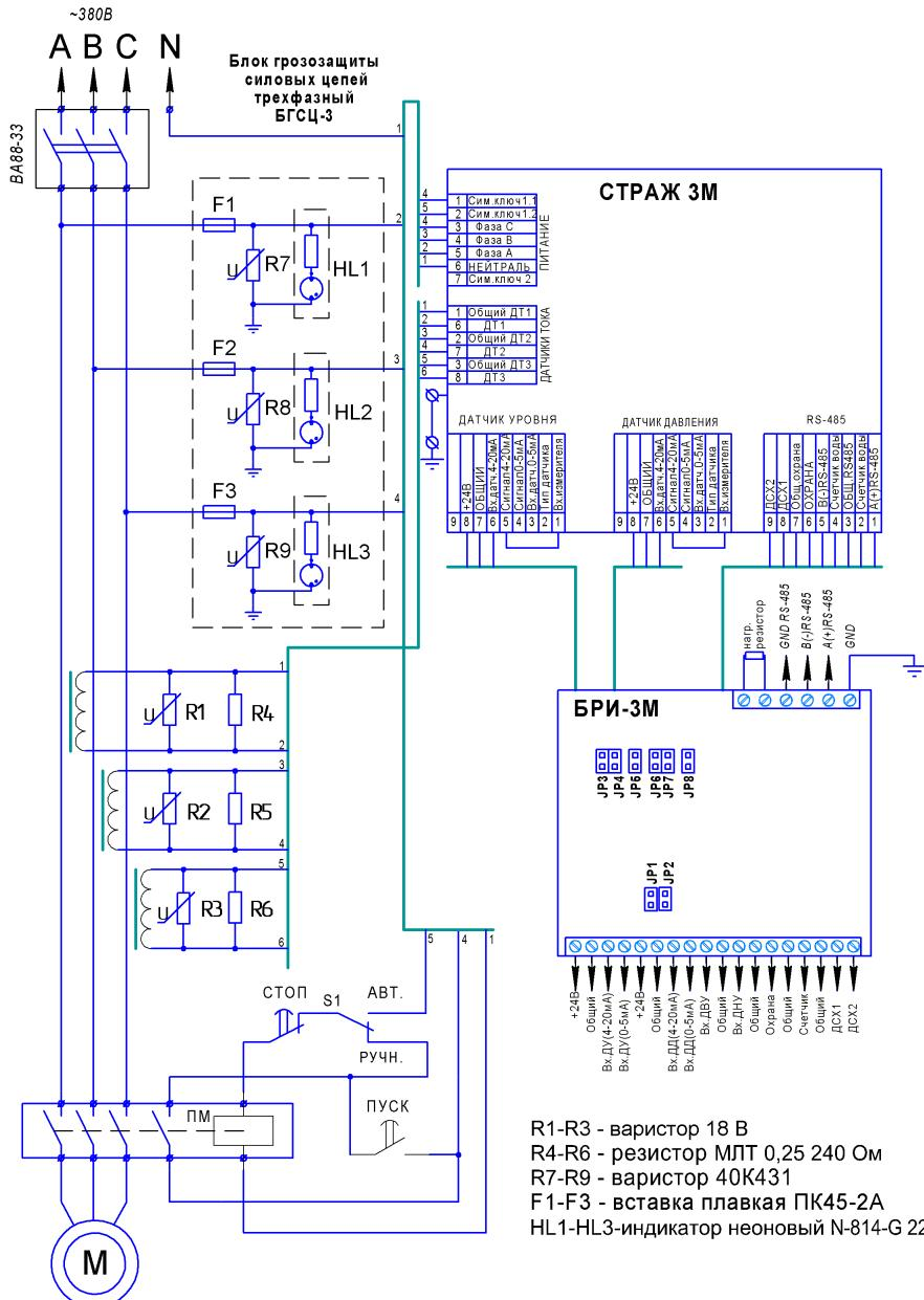
Рисунок 2 - Схема соединений станции управления погружным насосом СТРАЖ ЗМС-80А
